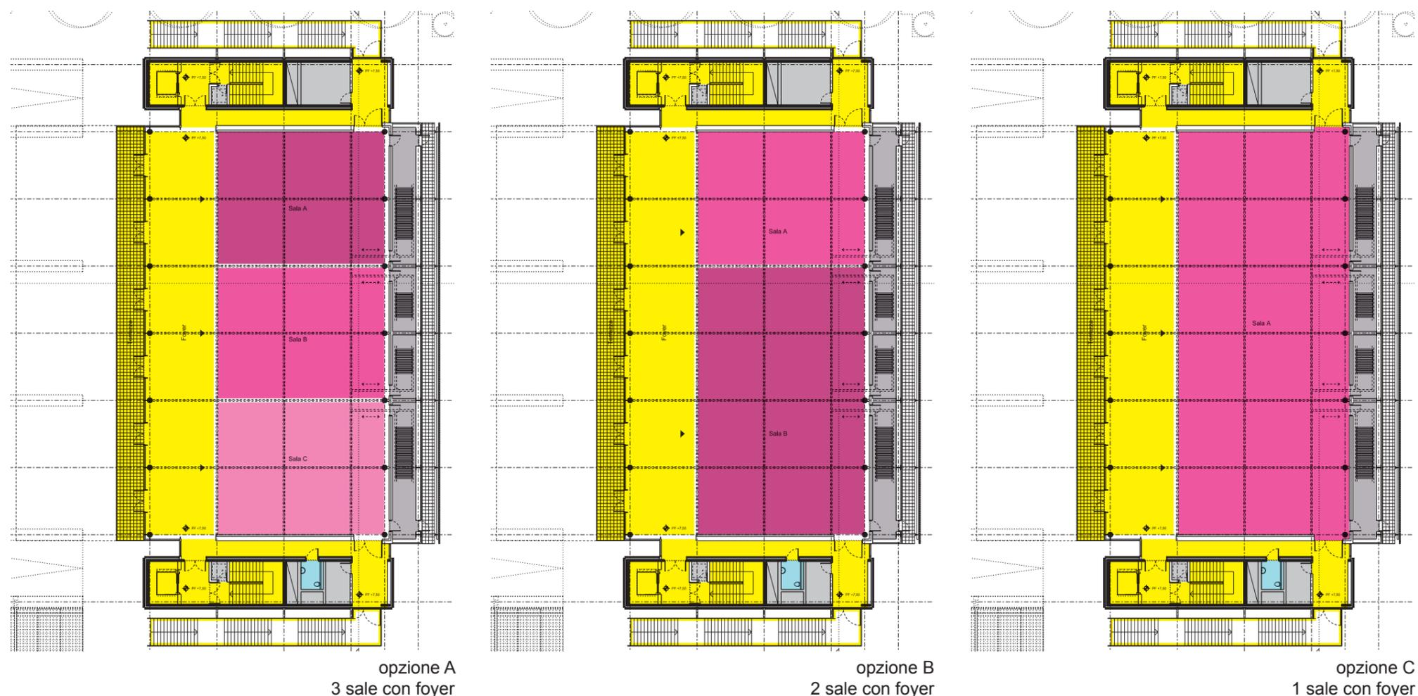
fig.55 Diagramma flessibilità sala polivalente
