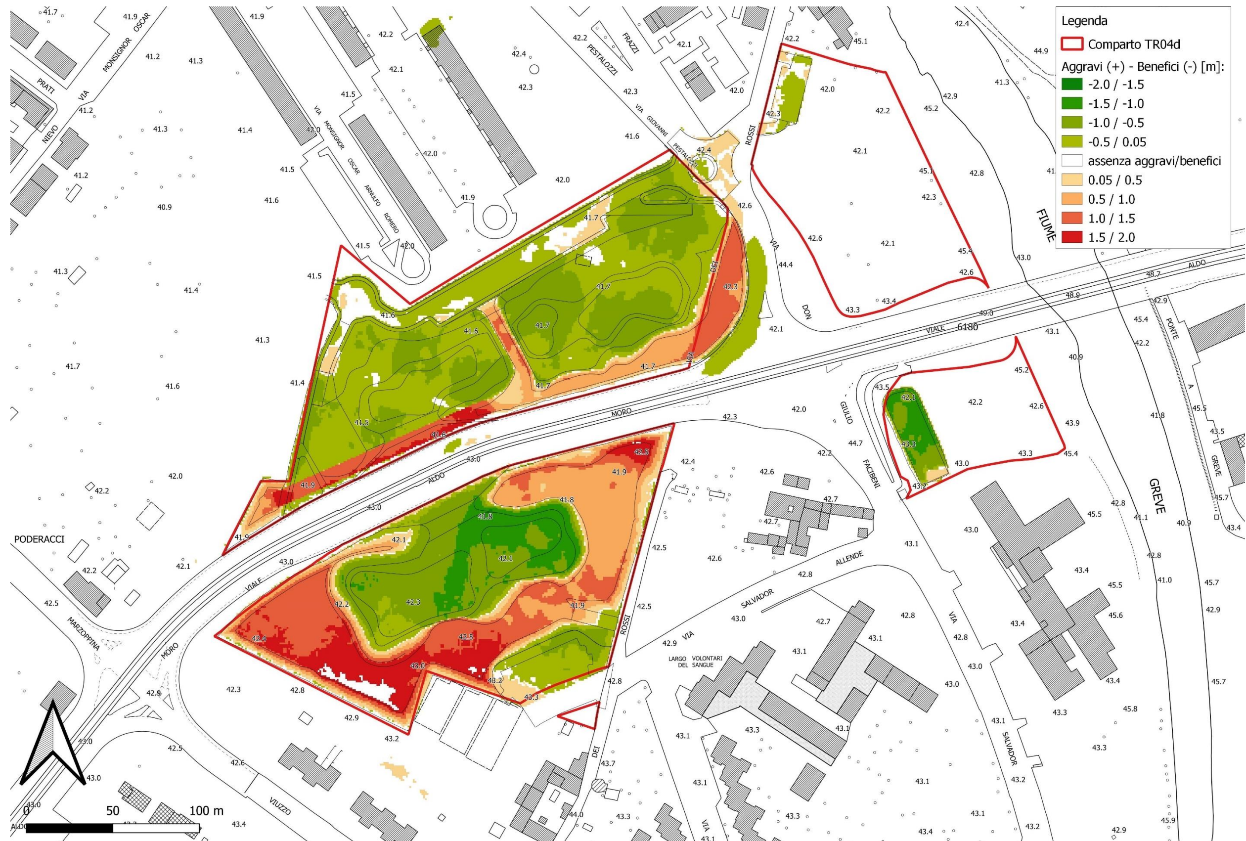
Figura 9-1 – Confronto battenti idrometrici stato progetto – stato attuale
