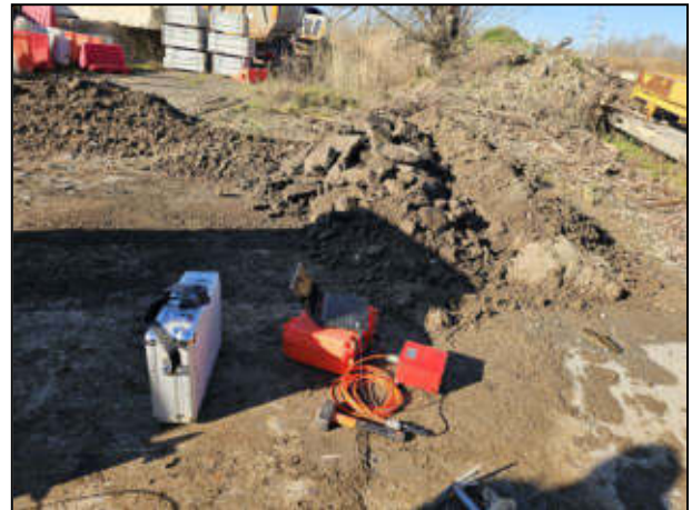
Fase di acquisizione misure di rumore HVSR.
