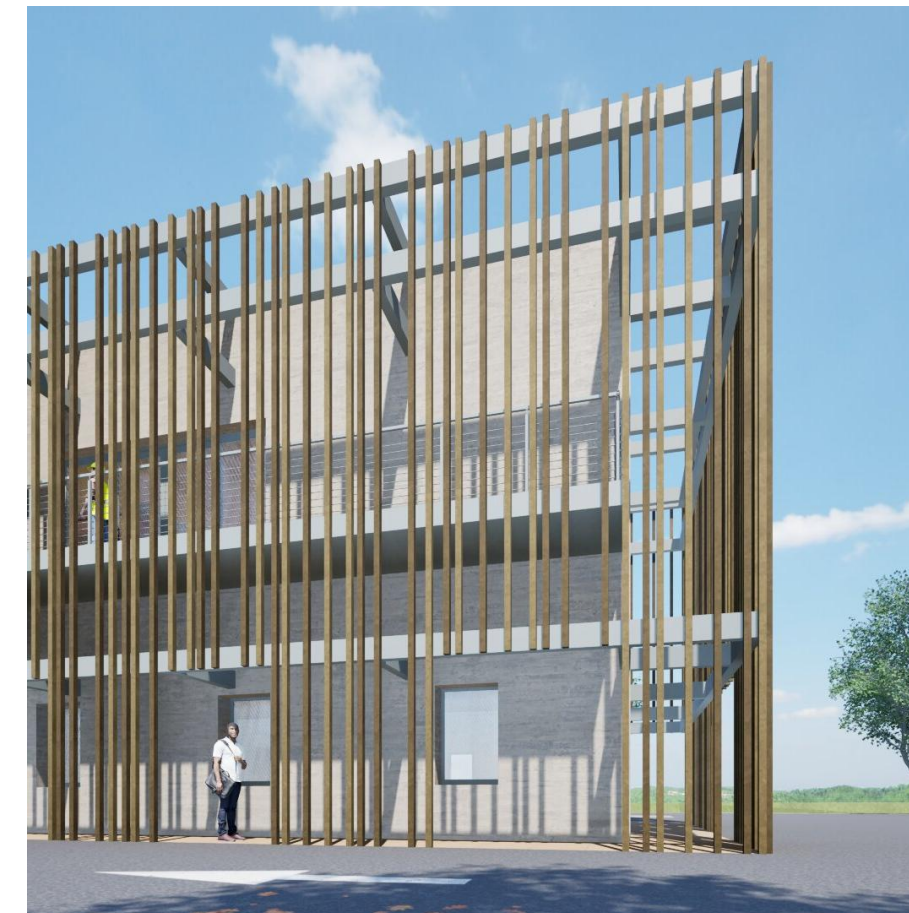
Figura 5-6: Dettaglio schermature verticali
