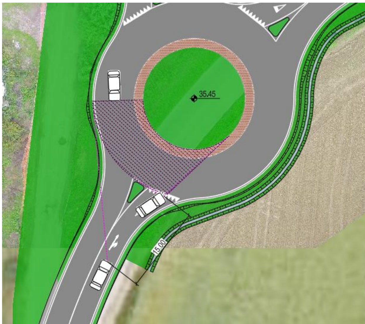
Figura 4-10: Angolo di visuale libera per verifica di visibilità
