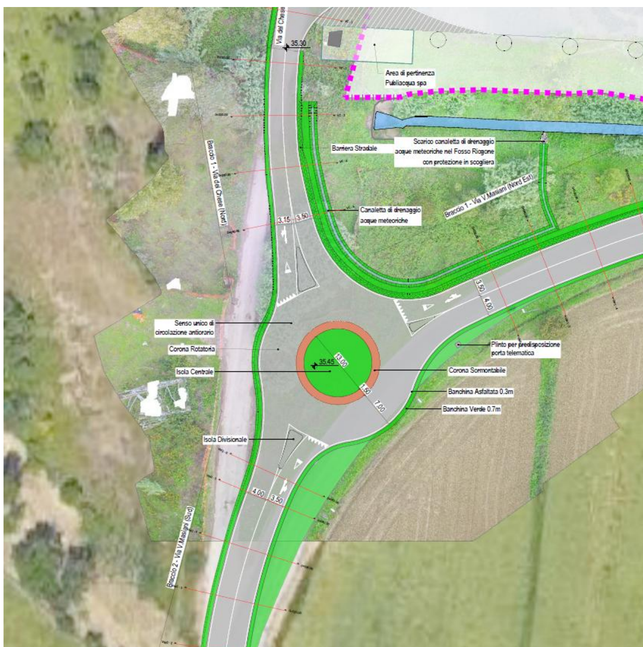
Figura 4-2: Nuova rotonda, planimetria di dettaglio
